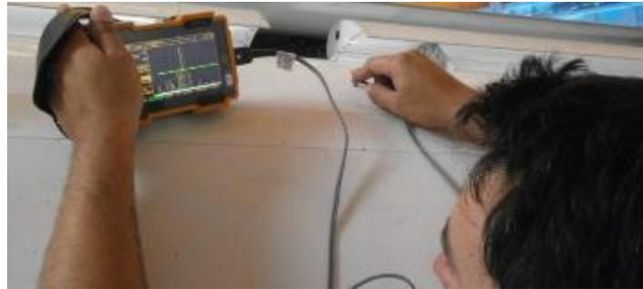
1. Medición de espesores con equipo USM GO.
